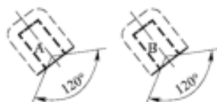
图 5.3.5-6 覆土库方位关系图: B 对 A——侧面到前面(无防护) A 对 B——前面(无防护)到侧面
